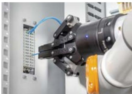
La technologie de raccordement SNAP IN est optimisée pour le câblage automatisé et robotisé.
