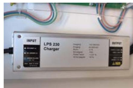
Les chargeurs à découpage ont une forme compacte et sont logés dans un boîtier.
