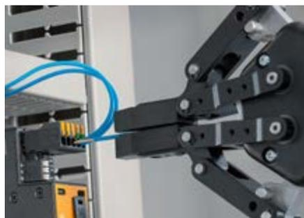
SNAP IN émet un signal sonore et visuel lorsque l'insertion du conducteur est réussie - essentiel pour le câblage automatisé de demain.
